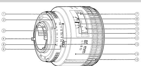
∩絞りリング Aperture ring Blendenring Bague des ouvertures Anillo de aberturas Anello dell'aperture 光圈環 光圈环 ⑦露出計連動ガイド Meter coupling ridge Steuerkurve Index de couplage photométrique Protuberancia de acoplamiento al exposímetro Indice di accoppiamento dell'esposimetro
